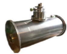
低ノイズ仕様LHeクライオスタット(PTB納)
