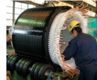
風力発電機 固定子組線作業
