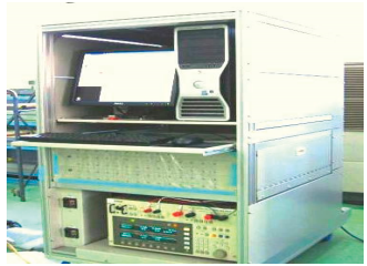
配電盤の自動試験装置
