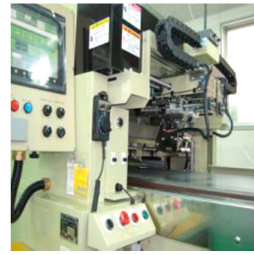
CCDカメラで位置決めを自動設定出来るプレス機
