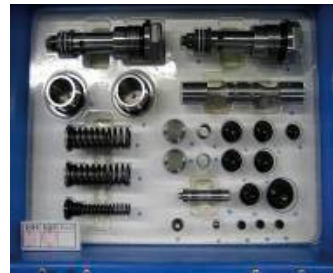
走行モーターに使用するリリーフバルブ、スプール等のパーツキット
