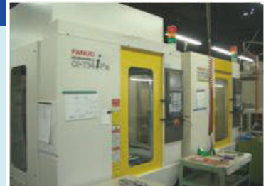
同時4軸制御/AI高精度輪郭制御 データサーバ、主軸MAX.24,000回転
