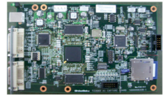
マイコン、大容量FPGAを使った、 特注基板
