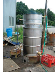
可搬式バイオエタノール製造装置 (筑波大学)
