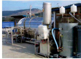
小型バイオガスプラント (霞ヶ浦バイオマスリサイクル開発事業)
