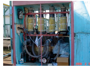
マイクロバブルを用いた生物脱磷装置 (自社開発製品/筑波大学と共同研究/JST)
