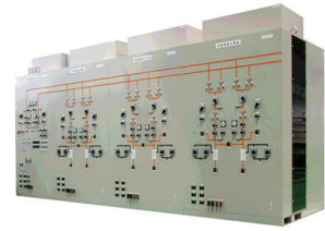
模擬送電線装置
