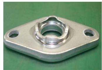
板厚4mmフランジ、「エンボス冷却仕様金型」
