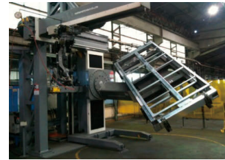
11軸強調 溶接ロボット
