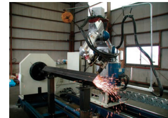
7m走行軸+360度制御 3Dプラズマ切断ロボット
