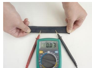
垂直配向CNT転写されたゴムシートを大幅に伸ばしても、導通が保たれている。
